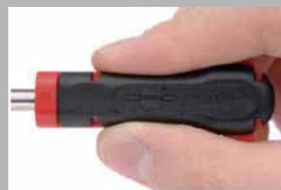
合手握柄設計，方便需精準施力的端子裝卸作業使用
