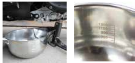
廢油直接導入盆內 (福士廢油盆) 廢油盆內雷雕容積刻度 方便檢測洩油量
