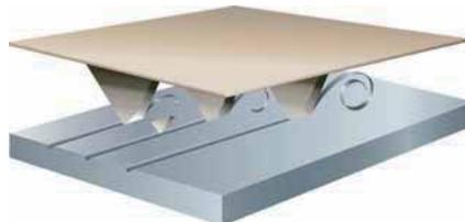
一致化的表面砂粒分佈均勻，並無凹凸不平。這可提供完美的研磨表現與表面拋光精細度。
